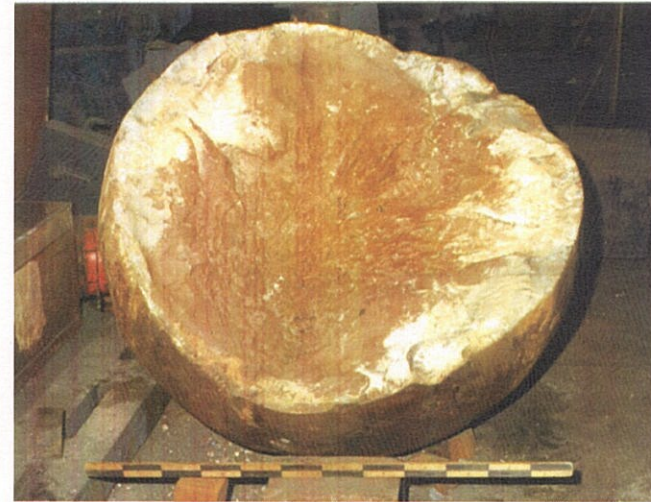
写真 球状鑄鋼品のロックキャンディ破壊事例
