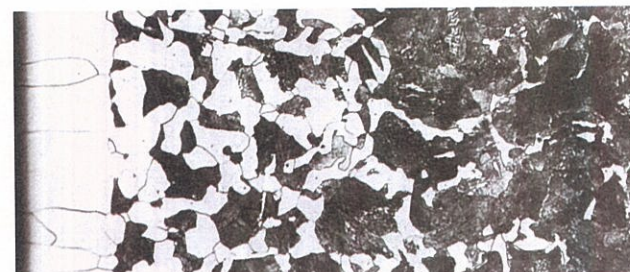
写真 1%の炭素鋼の脱炭組織
