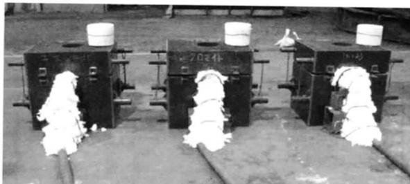
図5. 鋳型の配置写真(左から、人工砂、クロマイト砂、けい砂)
