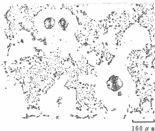
図1 チャンキイ黒鉛組織 (4ton, 220mm)
