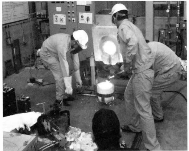
図 11 フリー窒素・スリーブ法による半凝固鑄造
